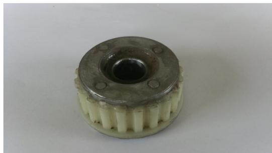
Das Zahnrad hat sich nur um das Maß der Scheibendicke verbreitert und passt haargenau in die Nähmaschine.
