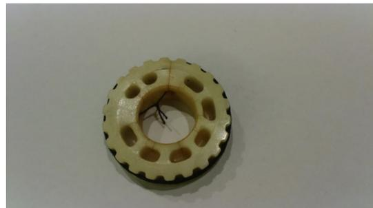
Die Buchse habe ich dann auf eine große Unterlegscheibe gelötet und plan abgedreht.
