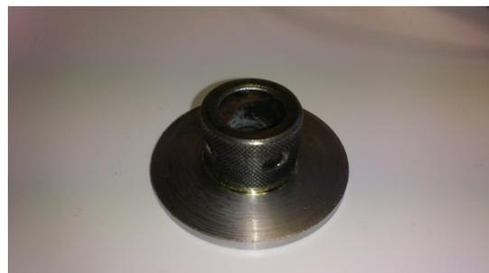
Außerdem habe ich das Loch im Zahnrad ein wenig ausgedreht so dass sich die Buchse spielfrei aber ohne Spannung einsetzen lässt.
